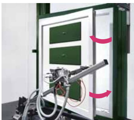
Тестване на прозорец за устойчивост при продължително натоварване
