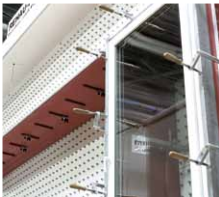
Оборудване за тестване налягането на вятъра
